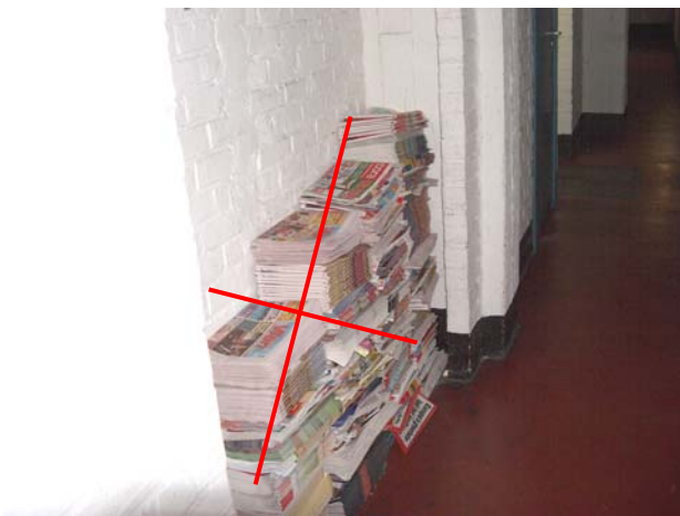
Te vermijden : Opgestapelde kranten in een ondergrondse gang : ideaal voor brandstichting (bron [8])
