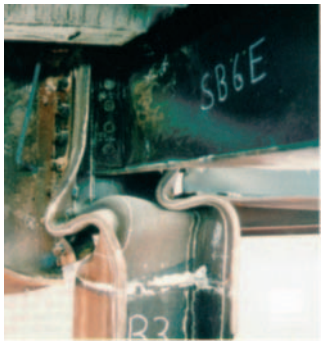
Fig. 14 - Chute de rigidité du béton et de l'acier [source : FEBELCEM]
